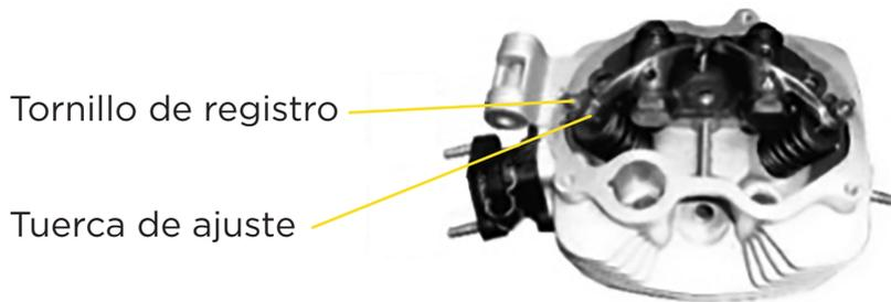
1. Sacar la tapa de válvula que se encuentra en la parte superior de la tapa de cilindro.
